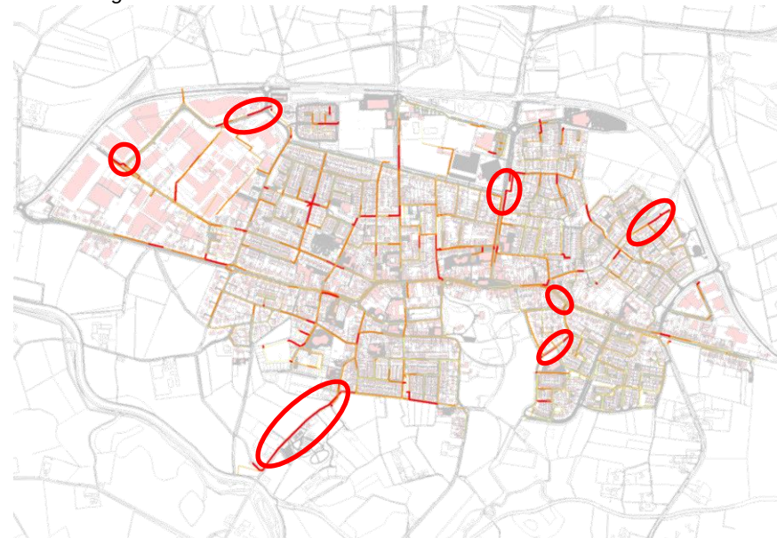
figuur 20 Stroomsnelheden bui 8 in aanvoerroutes overstorten
